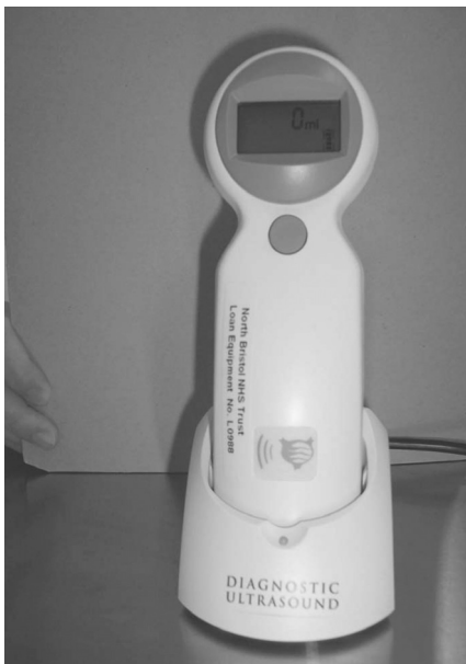
Şekil 3.24: Elde taşınabilir veya hastanın üzerinde taşıdığı ultrason cihazıyla klinikte, serviste veya hastanın odasında mesane hacmi/geride kalan idrar miktarı kolayca kaydedilmesini sağlar. Fotoğrafta ekranlı ultrason başı görülmektedir.
